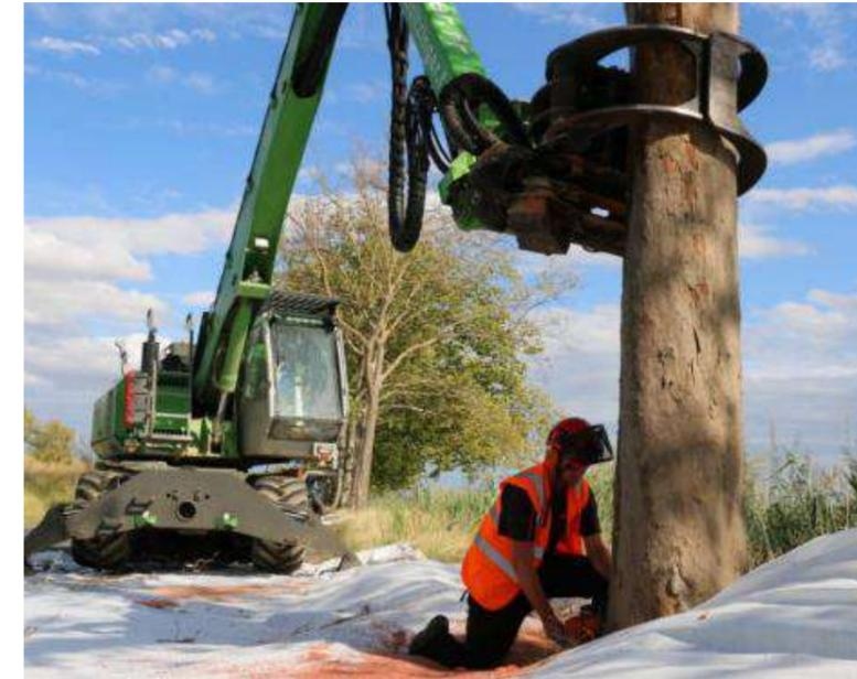
Photo 40 : Abattage assisté d'une pelle mécanique avec pince pour ralentir la chute
